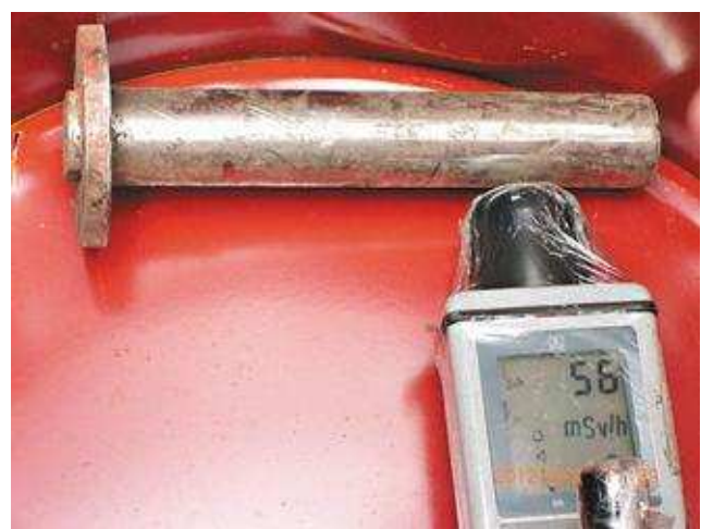
一家知名鋼鐵公司自越南進口的廢鐵含放射性的鈷六十，輻射源是一個三公斤重的法蘭型管路（主要用於管路接合）廢鐵。圖／高雄海關提供
