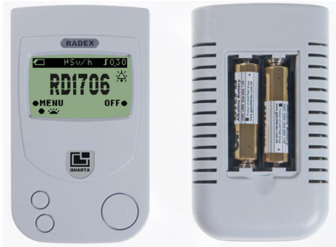
1706 型在該公司先前好幾種機型的基礎上經多次改進而成，大大縮短輻射測量時的觀測時間，提高顯示範圍，擁有更精確的檢測 X 射線的輻射的能力，1706 型非常方便運用於室內建築物及建築材料的檢測，本機型保留了先前機型所有後臺操作模式，作為報警系統的另外一個特點的震動信號也保留了下來。
